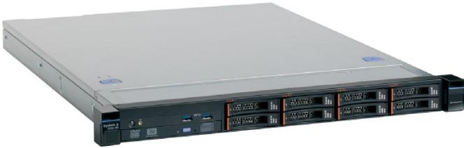
System x3250 M5 は、System x® ポートフォリオでも、最もコンパクトなラック型サーバーです。シングルソケットの 1U フォームファクターとしての設計では、同じ 559 mm の奥行き筐体でありながら、先行モデルの2 倍のシステムストレージ密度を誇ります (4 つの 3.5 型のハードディスクドライブ (HDD) または最大で 8 つの 2.5 型の SAS/SATA HDD)。<sup>1</sup> Xeon® データセンター・グラフィックプロセッサを含めて、Intel® Xeon® E3-1200 v3 シリーズ、Core i3、Pentium などの最新の Intel® プロセッサから、ワークロードに応じて選べます。
