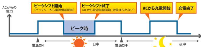
▲電力需要が高まる時間帯にACアダプター経由での受電をストップし、バッテリーで駆動するピークシフト機能
