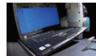
② 片もち落下試験 動作中のThinkPadの隅を持ち上げ数センチの高さから落下させる。
