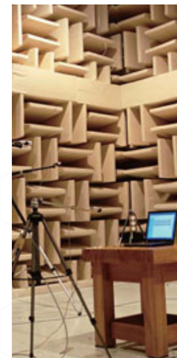
⑩ 動作ノイズ測定試験 音響測定用の専用の部屋でThinkPadの出す音を測定する。
