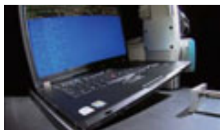
② 片もち落下試験 動作中のThinkPadの隅を持ち上げ数センチの高さから落下させる。
