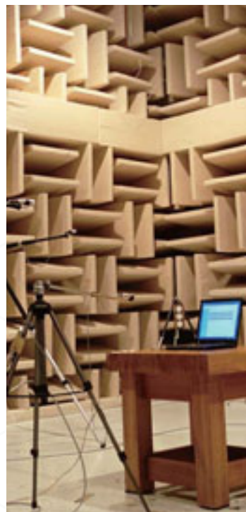
⑩ 動作ノイズ測定試験 音響測定用の専用の部屋でThinkPadの出す音を測定する。
