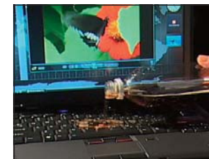
③ 拷問試験/液体滴下試験 キーボードに液体をこぼす。
