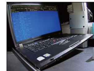
② 片もち落下試験 動作中のThinkPadの隅を持ち上げ数センチの高さから落下させる。
