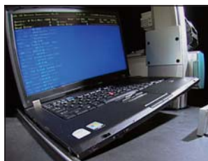
②片もち落下試験 動作中のThinkPadの隅を持ち上げ数センチの高さから落下させる。
