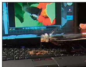
③拷問試験/液体滴下試験 キーボードに液体をこぼす。
