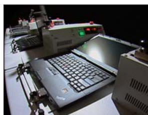
⑥液晶ディスプレイ開閉試験 液晶ディスプレイを数万回開閉する。
