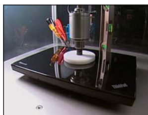
⑧LCDストレステスト 位置や圧力がかかる部分の面積を変えて繰り返し圧迫する。
