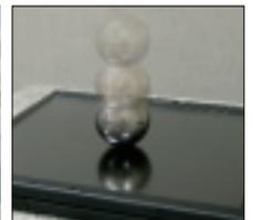
液晶面鉄球落下試験
