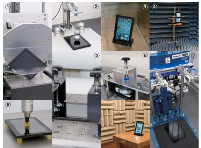
①角落下試験 ②液晶面鉄球落下試験 ③防滴試験 ④無線性能試験 ⑤反復繰り返し衝撃試験 ⑥加圧振動試験 ⑦自由落下試験 ⑧LCDストレステスト ⑨動作ノイズ測定試験
