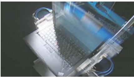
自由落下試験 オペレーティング・システムを起動し、ディスプレイを開けた状態のThinkPadを机よりも高いところから自由落下させます。
