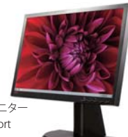
パフォーマンス・モデル Lenovo ThinkVision LT2452p Wide モニター 4420MB2 ・24インチ (1920×1200) TFTモニター ・アナログRGB、デジタルRGB、 DisplayPort
