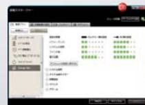
各機器の電力消費を精緻に制御し、長時間のモバイル使用を可能にする「省電力マネージャー」を搭載。詳細な電源管理が可能で、設定したモードに応じて使用しない機能を細かくカット。省エネルギー モードにすることでバッテリー使用の最大化を実現。事前に設定したプログラムに応じて機能を制御することも可能です。
