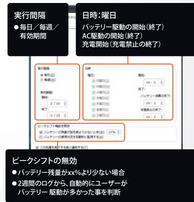
ThinkPad X1には、環境に配慮した「ピークシフト機能」を搭載。電力需要の低い時間帯に充電を行い、日の中の電力需要の高い時間帯をバッテリー駆動に自動的に切り替えAC電源をカット。バッテリー駆動に変えて電力ピークタイムの電力消費を抑えます。電源の不安定な場所では、ピーク時の突然の停電リスクを低減しデータ損失を回避するメリットもあります。
