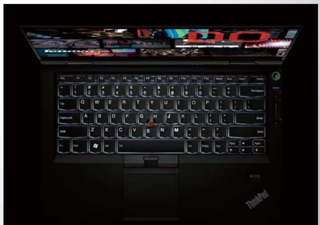
夜間や車の中、手元が暗い場所でも快適な操作が行えるLEDバックライトキーボードを搭載。ThinkPadならではのストロークやタッチ感まで吟味した上質な操作感を備え、使用頻度に応じたレノボ独自のキーデザインを採用。VoIPやビデオ会議時に操作しやすい専用コントロールキーも配置しています。
