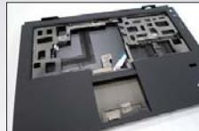
マグネシウム製のベースカバーとキーボードベゼルで、マザーボードを挟み込むように保護します。ThinkPad Roll Cageをさらに進化させ、最高レベルの堅牢性を実現。また表面ガラスには、イオン交換処理によりガラス基板表面に作った厚い圧縮層が防護板としてディスプレイを守るCorning®社のGorilla®ガラスを採用。ディスプレイ部の薄型化と堅牢性向上につながっています。
