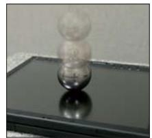
液晶面鉄球落下試験
