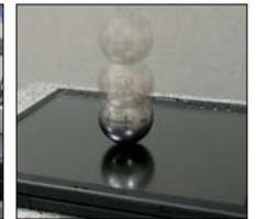
液晶面鉄球落下試験
