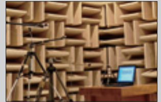
動作ノイズ測定試験
