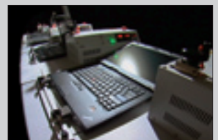
液晶ディスプレイ開閉試験
