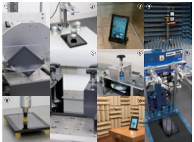
①角落下試験 ②液晶面鉄球落下試験 ③防滴試験 ④無線性能試験
