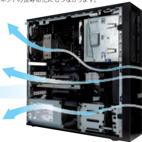
ハードディスク、グラフィックカード、CPUを効率よく冷却するトリプル・チャンネル・エアフロー
