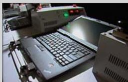
液晶ディスプレイ開閉試験
