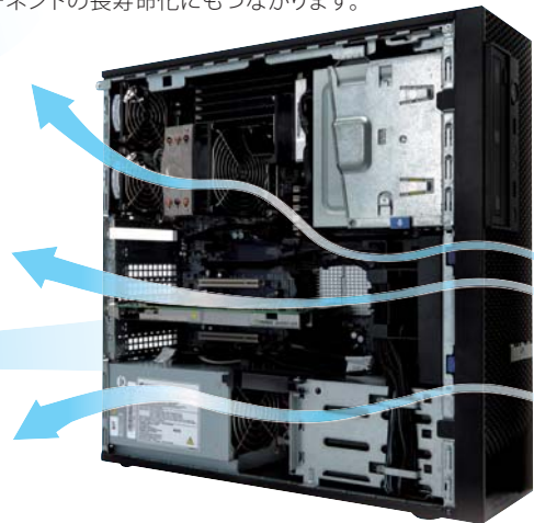
ハードディスク、グラフィックカード、CPUを効率よく冷却するトリプル・チャンネル・エアフロー ※写真は実物と異なる場合がございます。
