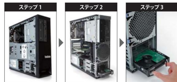
ステップ1 工具を使わずに開閉できる筐体
