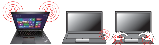
X1 Carbon Touchは感度の良好な2つのアンテナを液晶パネルの上部に装備
