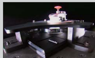
加圧振動試験
