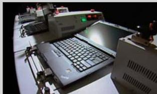
液晶ディスプレイ開閉試験
