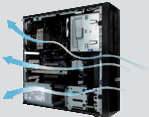
ハードディスク、グラフィックカード、CPUを効率よく冷却するトリプル・チャンネル・エアフロー
