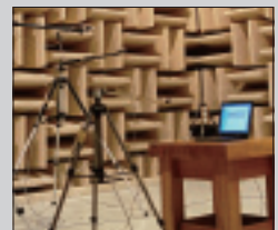
動作ノイズ測定試験
