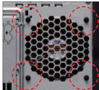
防振ゴムを採用し、ファンの振動を抑制
