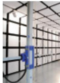
電波測定試験／無線ノイズ試験
