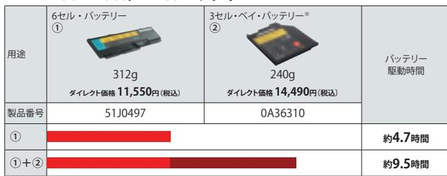
\*3セル・ペイ・バッテリーはベイドライブに装着して使用し、リチウム・イオン・バッテリーと組み合わせて使用することも可能です。
