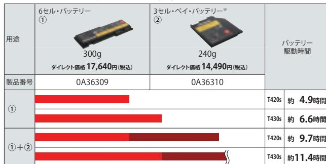
\*3セル・ペイ・バッテリーはベイドライブに装着して使用し、リチウム・イオン・バッテリーと組み合わせて使用することも可能です。
