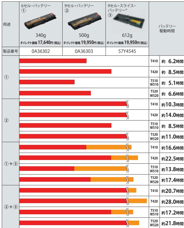
\*9セル・スライス・バッテリーは本体底部に装着して使用し、リチウム・イオン・バッテリーと組み合わせて使用することも可能です。
