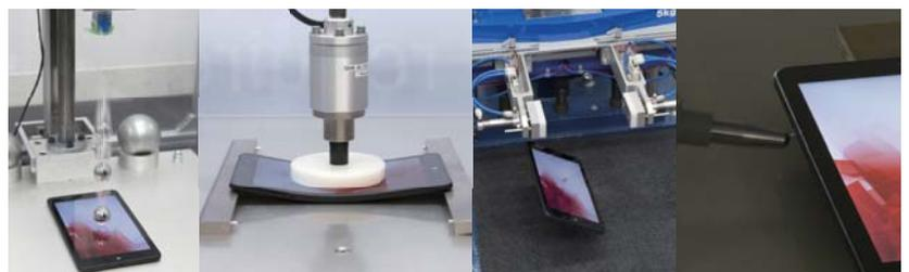
液晶面鉄球落下試験
