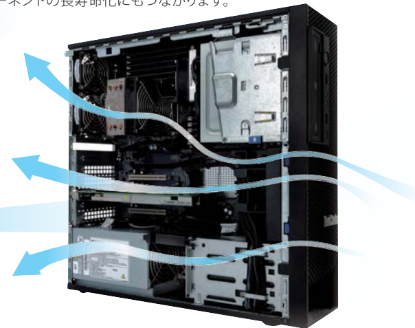
ハードディスク、グラフィックカード、CPUを効率よく冷却するトリプル・チャンネル・エアフロー ※写真は実物と異なる場合がございます。
