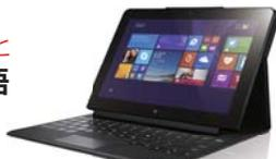
キーボードとカバーが一体化したケースです。キーボード部分にはタッチパッドを搭載し、デジタイザペンを格納するホルダーがついています。カバーにはカメラ用の穴もあり、閉じるとタブレットがスリープモードになる設計です。
