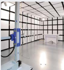
電波測定試験/無線ノイズ試験
