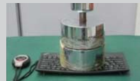
キーボードの中心におもりを置き、キーボードの足(チルトスタンド)が変形しないかを検証
