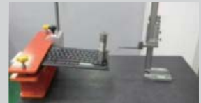
おもりを置いての剛性テスト。ねじれが規定値以下になるよう設計
