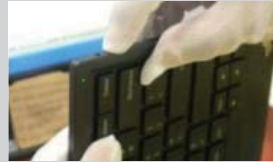
スイッチのオン・オフテストを相当回数実施のうえ、スイッチとして継続利用が可能かを確認
