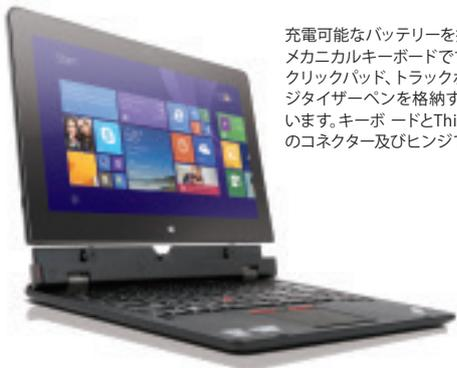
充電可能なバッテリーを搭載した薄型設計のメカニカルキーボードです。このキーボードはクリックパッド、トラックポイントを搭載し、デジタルペンを格納するスロットもついています。キーボードとThinkPad Helixは専用のコネクター及びヒンジで接続されます。
